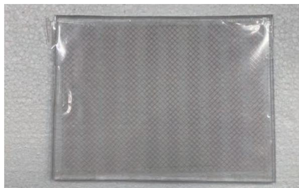
写真9 50μm線幅の電波反射板
