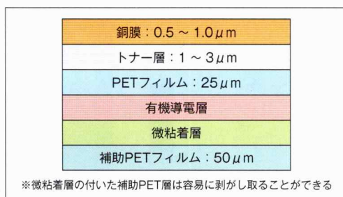
図5 電気印刷で作製される製品の基本構成
