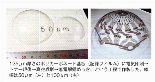
図8 球面に作製した銅のメッシュ模様と電気回路
