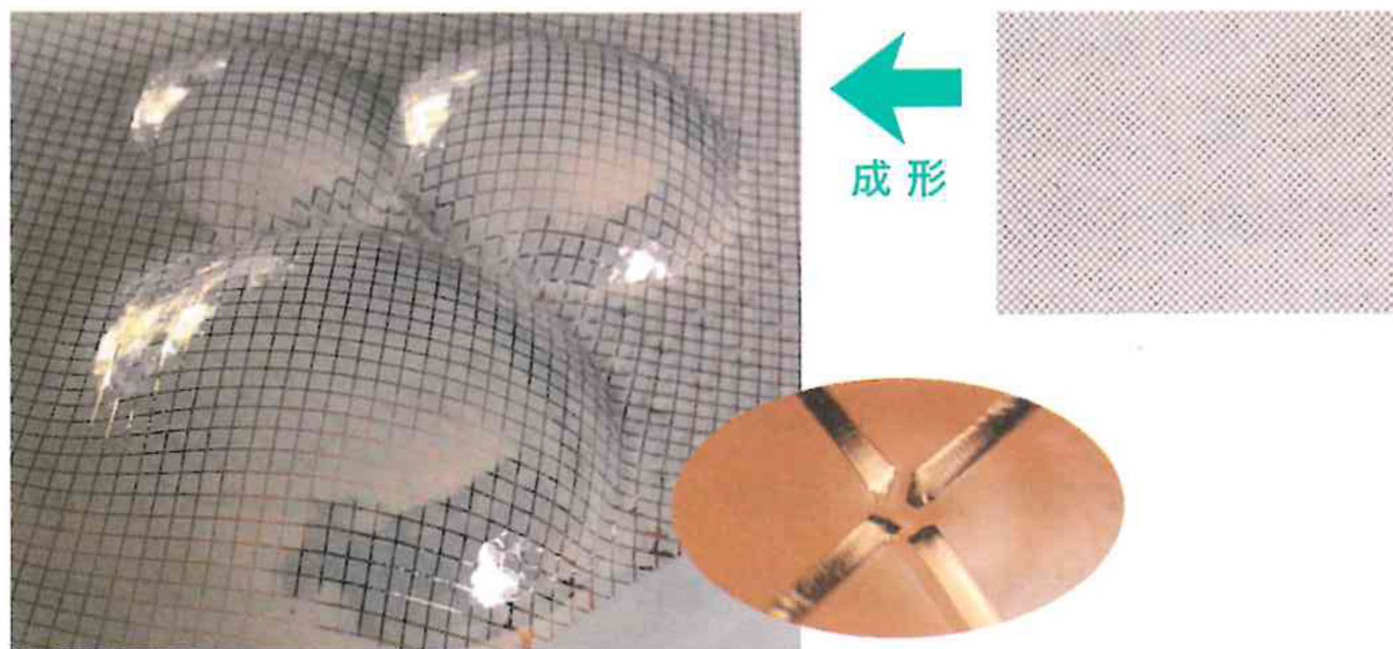
図7 半球状（3次曲面）に加工した電気回路は断線
