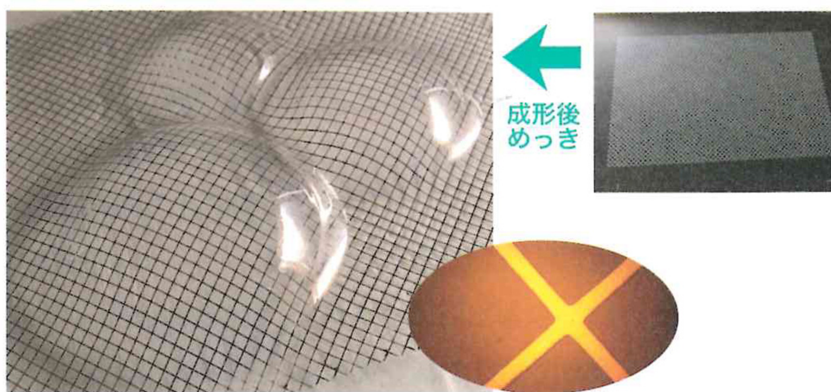
図8 断線のない電気回路
